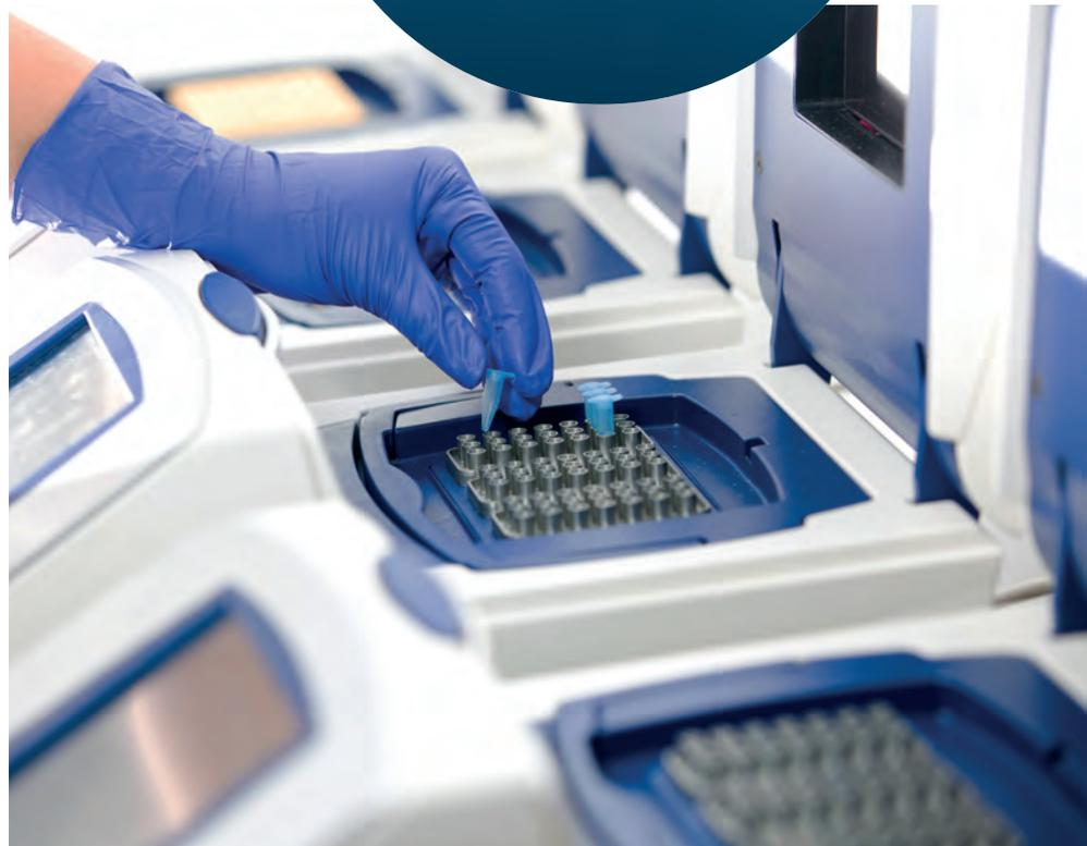
Un termociclador de PCR es un aparato usado en biología molecular para generar una reacción en cadena de la enzima polimerasa, lo que permite amplificar el ADN para su análisis.
